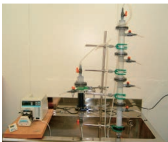
図2 カラムを利用した吸着試験
