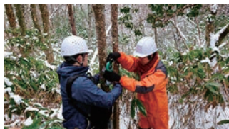
小流域での積雪深の自動観測カメラの設置
