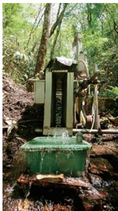
三瓶演習林小流域での流量観測
