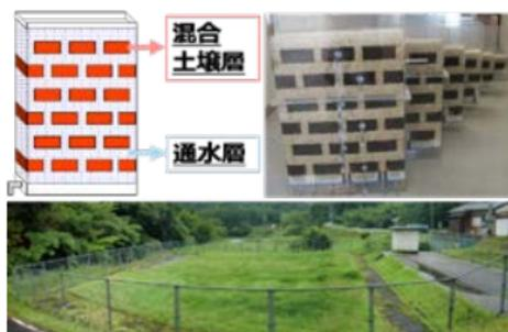
図1 多段土壌層法の概略図(左上)と室内実験用のモデル装置(右上)です。下の画像は集落排水処理で実際に使用されている装置です。
