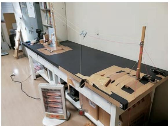
図1 架線集材の模型実験
