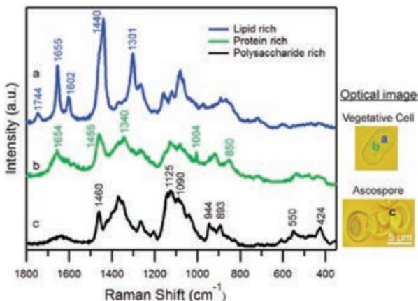
分裂酵母という細胞のいろいろな位置で測定されたラマン散乱光
