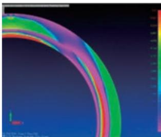
補強した管路の強さを推定するための
