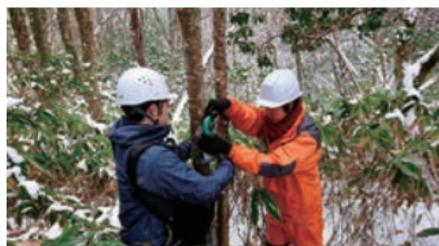
小流域での積雪深の自動観測カメラの設置
