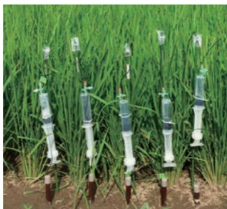
図2 地面に装置を挿して、地下水を採取している様子。注射器内に水が溜まっています。
