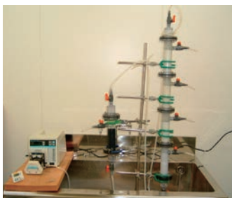
図2 カラムを利用した吸着試験
