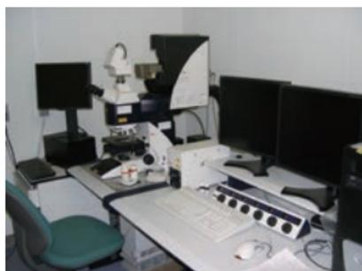
図3 共焦点レーザー蛍光顕微鏡
