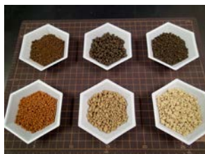
図2 攪拌機や造粒機で作成した土壌の粒状物です。土壌分野ではこのような土粒子の集合体を団粒と呼びます。様々な資材も混ぜ込んで、水質浄化能を高めます。
