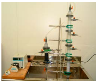
図2 カラムを利用した吸着試験
