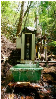
三瓶演習林小流域での流量観測
